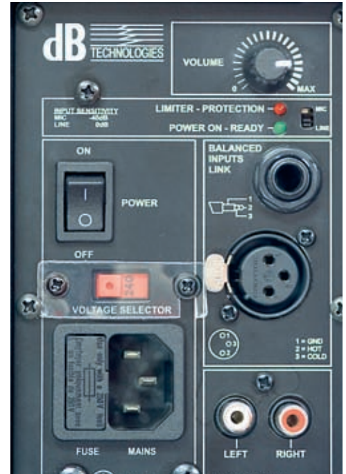
K162 von dB Technologies: Das Anschlusspanel.
